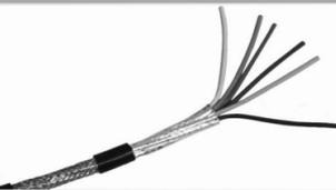
采用镀锡铜编织屏蔽层工艺及护套线挤压工艺。永不氧化,较裸铜抗干扰效果好30%;接头容易焊接;RVV挤压式搪套线,电缆绝缘与护套之间采用优质滑石粉间隔,空隙处均用PVC填满,一次挤压成型。耐磨抗拉,防水防晒防酸防碱。可用于户外管道、挂空,使用范围广,不易破皮漏电;用于户外防盗报警上,传输稳定,使用寿命长,基本不用维护。使用寿命10年左右。
