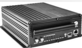
专业为车辆长时间录像监控而设计,支持4路音视频同步录像,采用大容量硬盘,满足用户对高清图像长时间存储的需求。采用先进硬盘防震技术,保证在复杂路况下仍能正常工作,同时支持GPS定位、G-sensor、3G、WiFi等功能。设备支持CMS监控调度管理平台软件对车辆进行远程监控管理,通过3G实现远程报警、联动、音视频实时监控。采用工业设计标准,功能齐全,性能稳定,适用于大巴、货车、公交等车辆录像监控。
