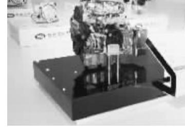
共轨直喷技术(CRDI),其喷油压力达到1600bar,远高于汽油机,因此能得到更好的燃油雾化效果。另外,在确保燃油效果的同时要提升发动机扭矩,其关键点就在于提升燃烧质量和排气效率。新一代电控高压共轨直喷技术(CRDI)和可变
