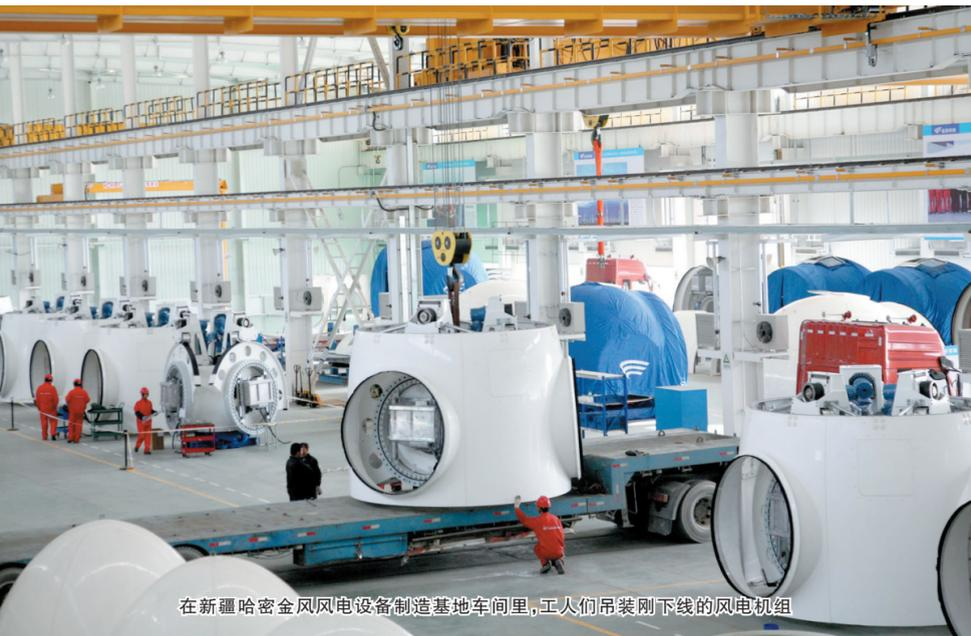
在新疆哈密金风风电设备制造基地车间里,工人们吊装刚下线的风电机组。
