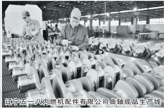
辽宁五一八内燃机配件有限公司曲轴成品生产线
