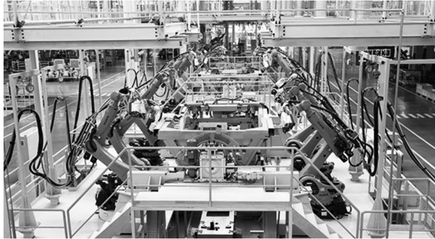
图为吉林长春奥迪Q工厂焊装车间高自动化率焊装生产线。
