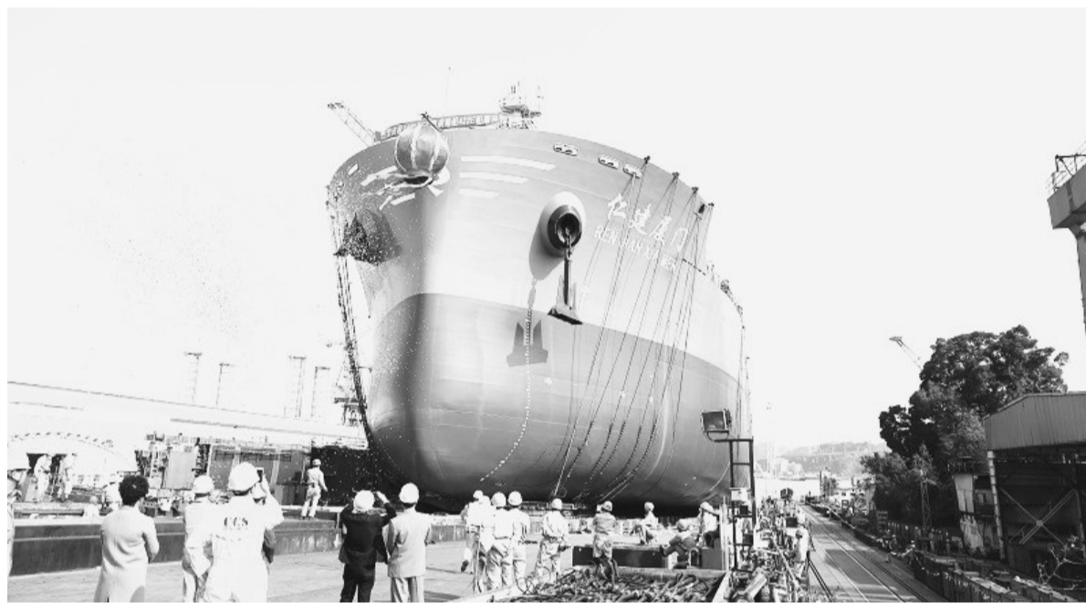
近日,厦门船舶重工股份有限公司承造的第五艘2400TEU集装箱船“仁建厦门”顺利下水。该轮是厦船重工股份有限公司2018年第一艘下水的集装箱船,船舶总长180米,垂线间长177米,型深16.2米,设计吃水10.7米,航速14.5节。
