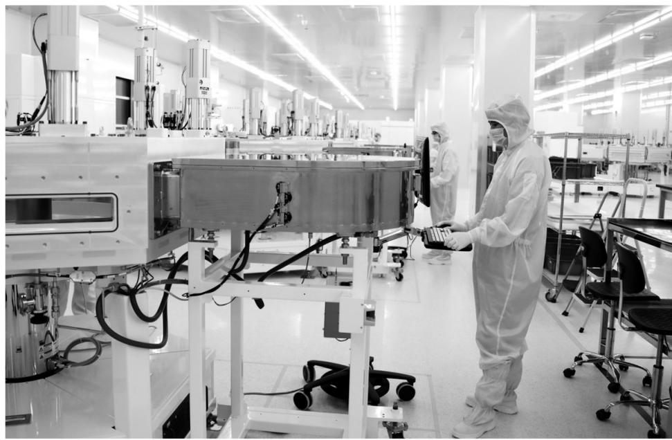
位于江西南昌高新区的高端芯片设备企业——南昌中微半导体设备有限公司研发的MOCVD设备投放市场后,打破了美国、德国的设备垄断局面,使中国LED产业告别了从国外进口核心设备MOCVD的历史。图为南昌中微半导体公司内,工程师调试LED高端设备MOCVD。
