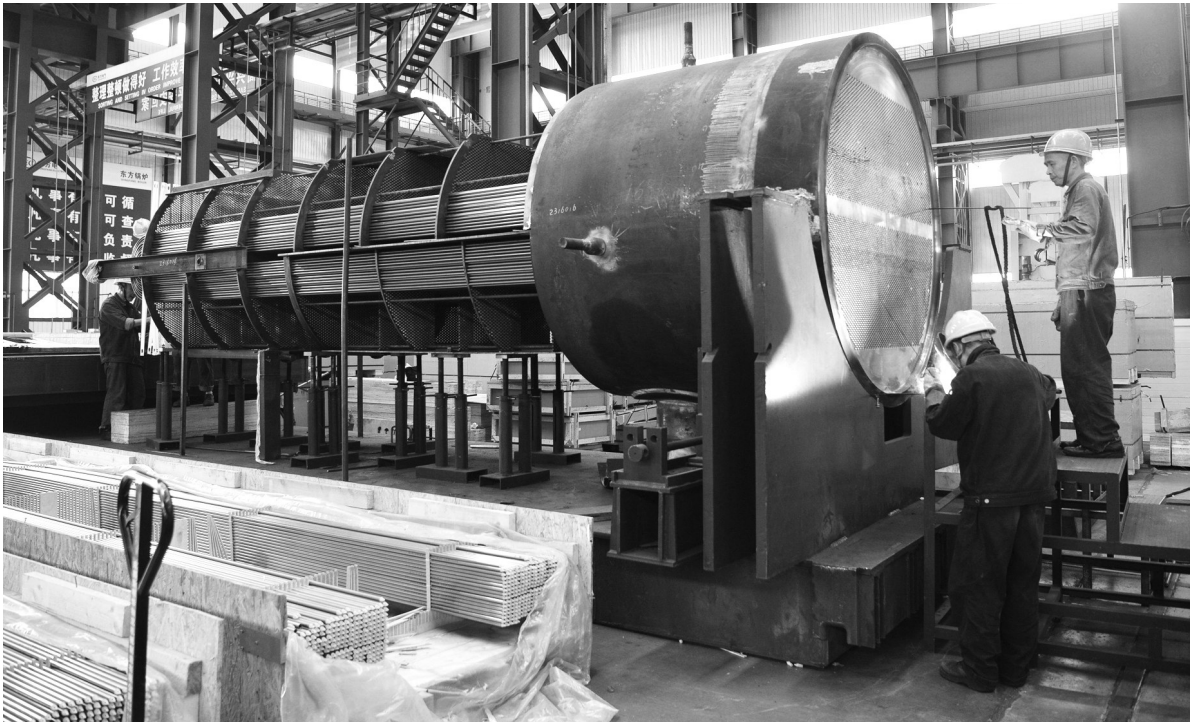
位于“重装之都”四川德阳的中国东方电气集团东方电机有限公司是一家生产大型工业设备的企业,该公司近期拿下了巴西杰瑞水电站项目,为该水电站研制生产了22台巨型贯流式水轮机组。图为中国东方电气集团下属子公司厂房内,工人正在加工零部件。
