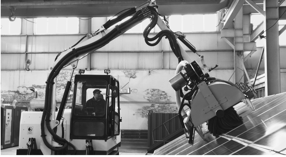
目前,国内光伏产业发展迅速,光伏清洁设备虽然形式和生产厂家众多,但只能适用于铺装路面和道路较好的光伏电场,对于沙漠、山地等地形只能望“板”兴叹。对此,河北省张家口市泰达机械设备制造有限公司利用两年时间攻关,采用全液压底盘适应各种复杂路况,实现了智能化运行。该车每台日可清洗光伏板2兆瓦,是人工清洗效率的10倍以上,目前已获得国家专利,即将进行量产。
