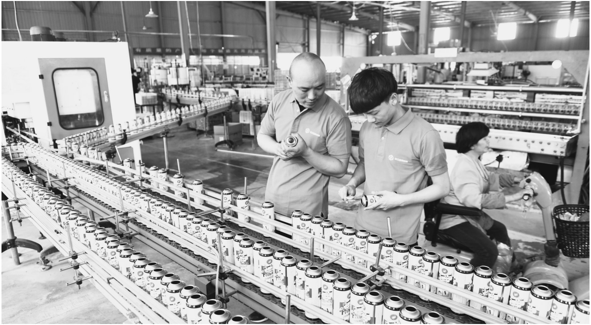
位于浙江省东阳市巍山镇六怀工业功能区的金华市巨久金属包装有限公司生产各型号气雾罐,可运用于环保制冷剂、杀虫剂、空气清新剂、工业气雾剂、娱乐气雾剂等产品上,目前主要销往巴西、阿根廷、智利、埃及、印度等十几个国家。图为在该公司车间里,刚自主升级改造完成的高速全自动化生产线正在开足马力生产气雾罐,满足出口业务快速增长的需求。
