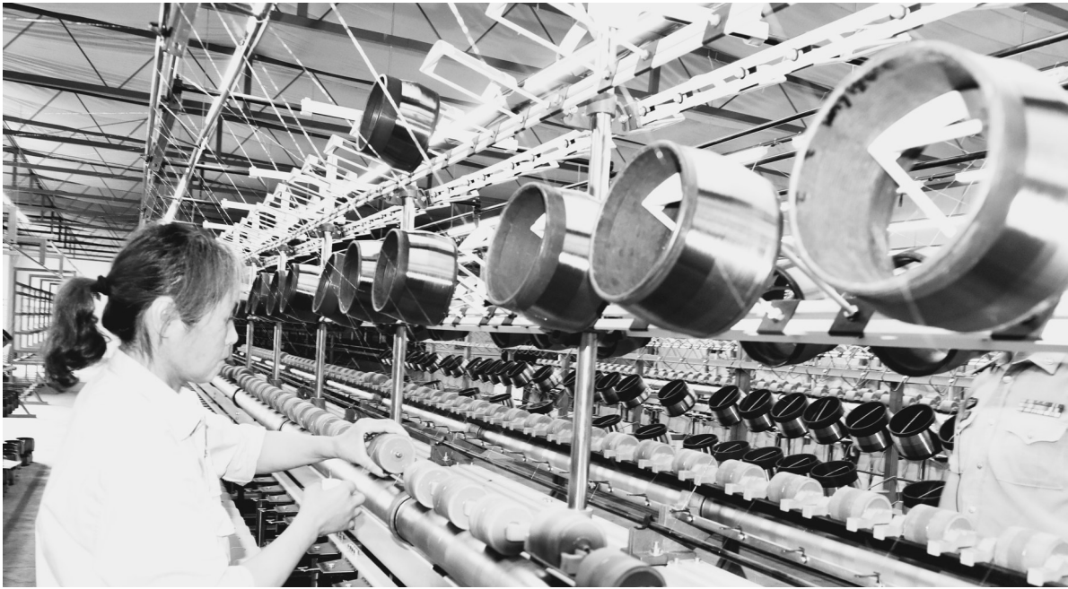
江苏天龙玄武岩连续纤维维高新技术有限公司是一家集玄武岩纤维产品生产、研发、销售为一体的企业,依托中科院地质与地球物理研究所、乌克兰国家科学院的技术研发力量,对连续玄武岩纤维生产的原料配置、工艺优化、现代化规模化生产技术进行研究,建有高技术含量的连续玄武岩纤维生产线。图为工人正在利用从石头中拉出的纤维纺纱。
