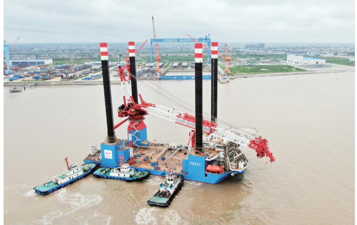
我国海上风电建设再添“大国重器”——中国首艘1300吨自升自航式风电安装船“铁建风电01”近日在江苏启东中远海运海工成功下水,该船融合了当前世界最新科技,多项技术打破国内记录,是目前国内最先进、综合性能最高的海上风电安装船舶。
