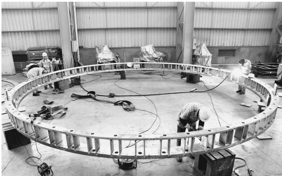
近年来,江苏省无锡市充分利用不锈钢交易平台的辐射优势,积极参与“一带一路”建设,推动当地经济发展。无锡市锡山区作为全国最大的不锈钢材料贸易加工基地之一,规模以上的金属制品企业有125家。图为工人正在为出口中东地区的制糖工业设备结晶罐焊接直径8.2米的不锈钢底座。
