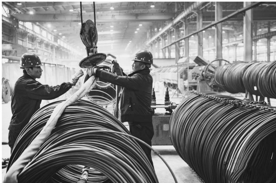
近年来,陕西省汉中市勉县坚持循环发展理念,以周家山循环经济产业聚集区、褒城新型材料产业聚集区和中小企业孵化园为依托,全力推动工业转型升级。图为汉中市禹龙科技新材料有限公司的员工将钢筋进行物理冷拔处理。据了解,该项目年产10万吨混凝土用钢筋钢绞线,新增就业岗位150余个,实现利税3000多万元。
