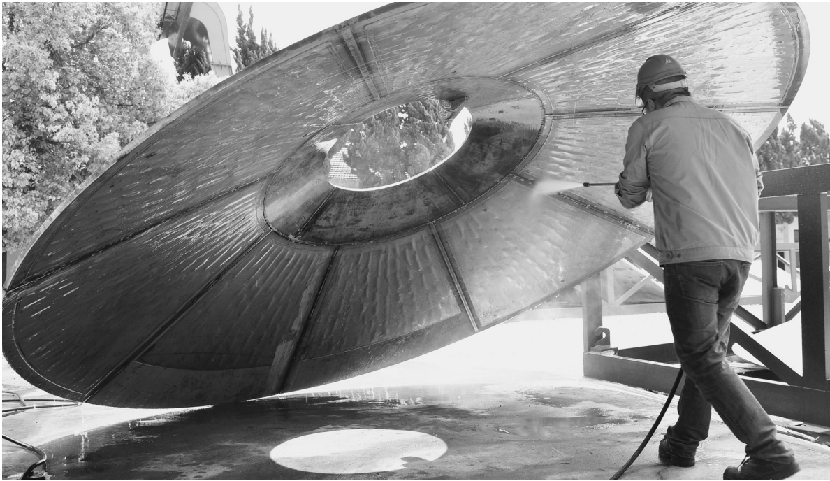
中东地区制糖工业设备项目被国内一家工程设计院中标后,由大明国际控股有限公司承揽,预计5月初全部交付出口。图为工人在清洗焊接后的制糖结晶罐锥体上盖。 本报通讯员 杨木军 摄
