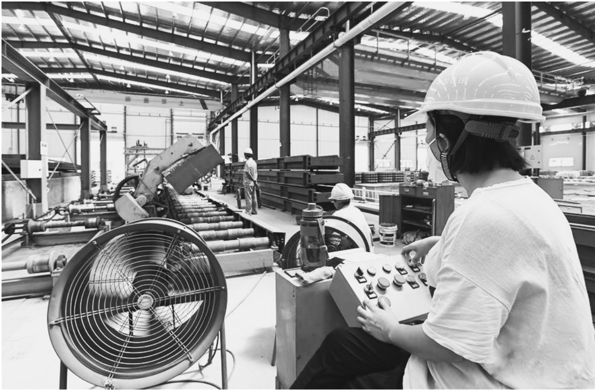
为高效服务粤港澳大湾区基础设施建设,中铁建华南建设有限公司在广州番禺区和南沙区设立3家装配式工厂,形成华南地区目前规模最大的钢材和混凝土制品加工配送中心。图为工人在该公司南沙混凝土制品加工中心操控地铁轨枕翻模机。
