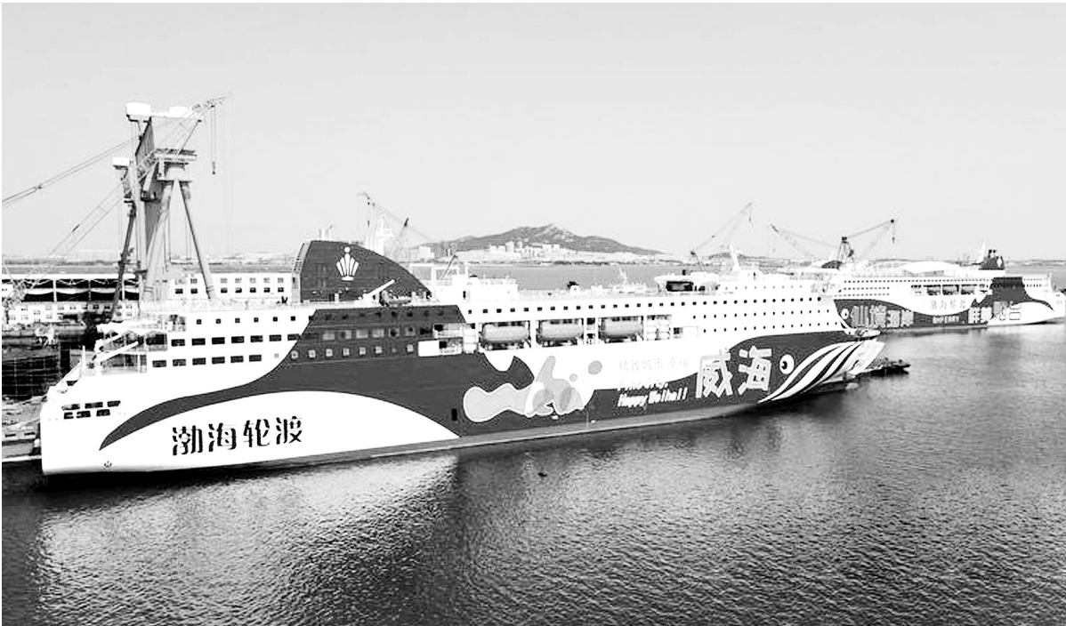
9月22日，山东省荣成市石岛管理区黄海造船有限公司，工人正在对即将交付使用的大型豪华客滚船“中华富强”号涂装蓝鲸图案、“精致城市，幸福威海”中英文对照图标。其与“中华复兴”号姊妹船蓝鲸底、“仙境海岸，醉美烟台”图标相协调，成为股东半岛经济圈新亮点。 “中华富强”号总长185米，型宽28.6米，总吨位3.7万吨，乘客定额为2300人，该船主要用于国内远海航线承运旅客、轿车、载重汽车和集装箱拖车，投入运营后将往返威海至大连航线。 中新社发 杨志礼 摄
