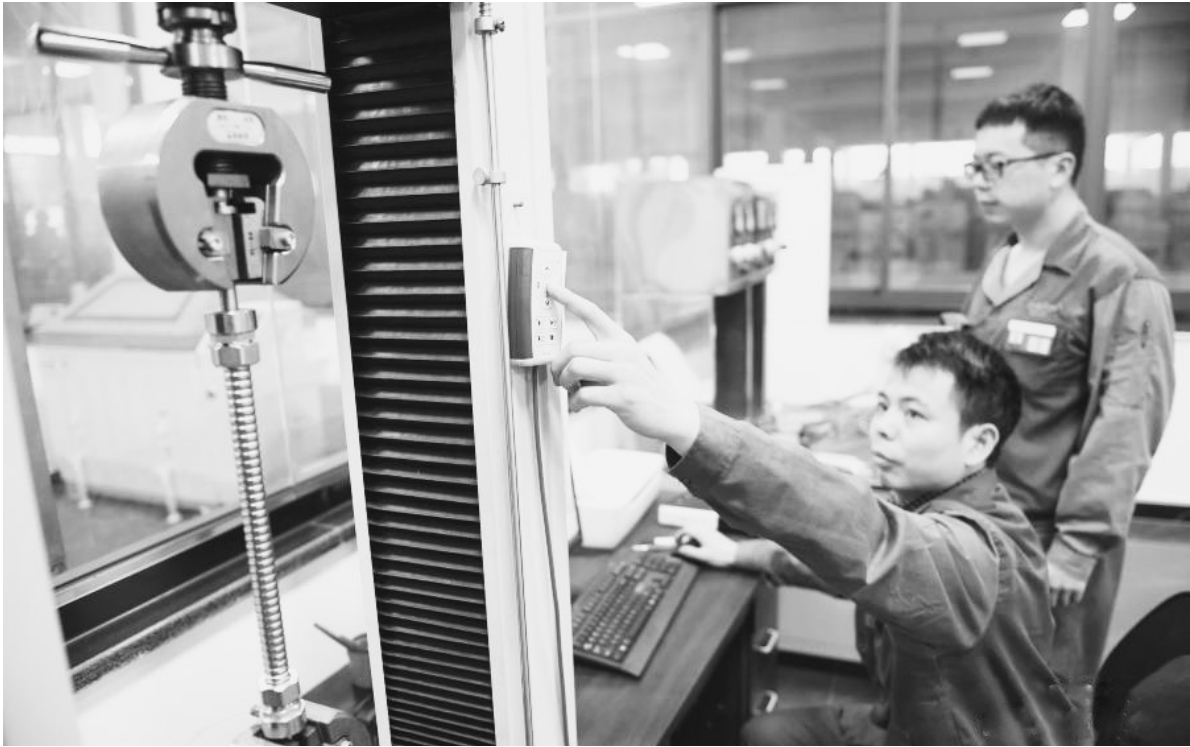
近年来,浙江制造业重镇诸暨市店口镇积极推进企业全流程智能化改造,加大科研力度,使生产管理更为精细高效。1至10月,店口镇规上工业产值30亿元,自营出口63.89亿元,实现逆市增长。图为工作人员在实验室进行不锈钢波纹管拉伸试验。
