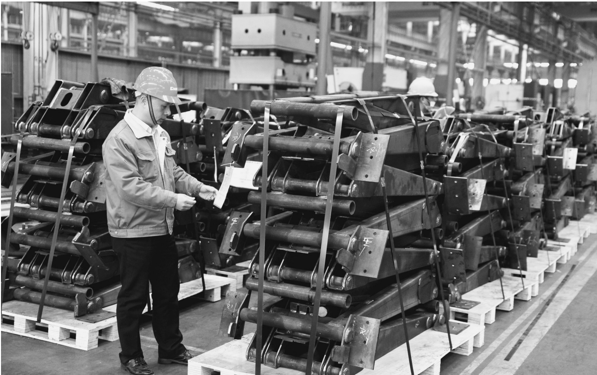
自2017年底，江苏省靖江市工业园区大明金属科技有限公司承制了美国拖车的液压装置。拖车液压装置较为繁杂，部件之多达50多件，加工涉及材料切割、折弯、焊接等工序。图为该公司工人正在整理发运美国的拖车液压装置。
