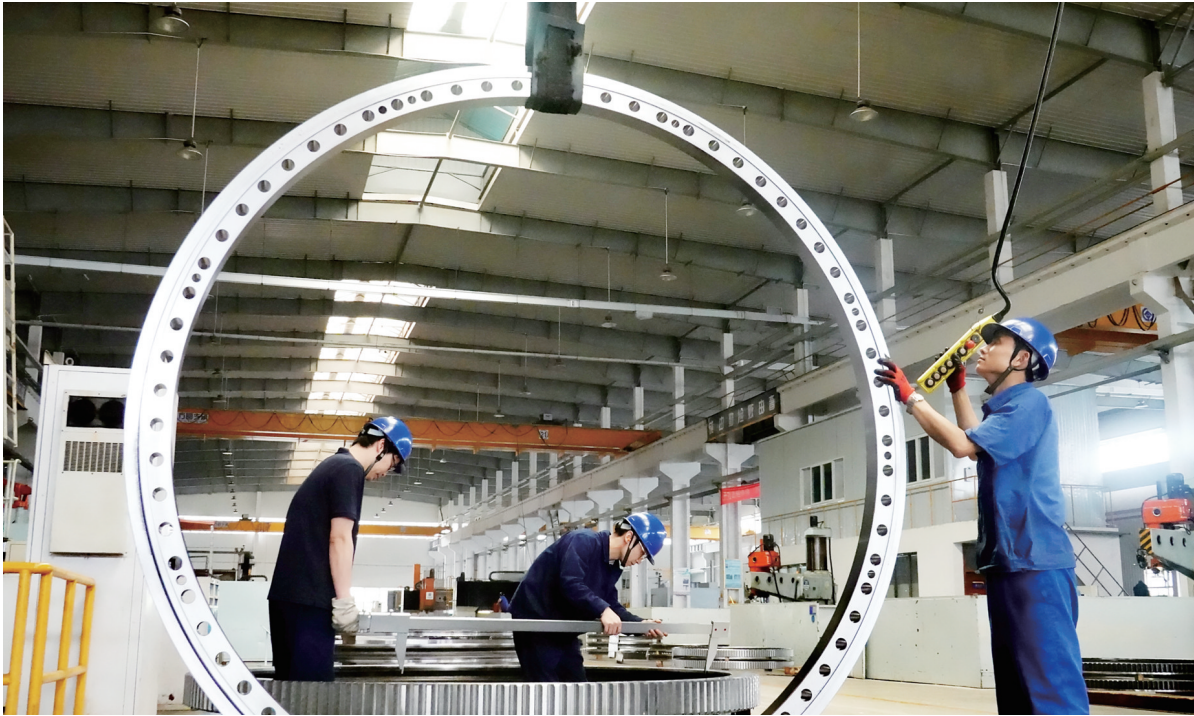
近日,在安徽省马鞍山市经济技术开发区的方圆精密机械有限公司里,员工正在忙着生产回转支承。近年来,该公司加大自主创新,先后研发具有国际领先的单球排式、鼓形齿式等300多种回转支承,产品远销美国、加拿大、日本、意大利、俄罗斯等海外市场,实现国际国内市场双循环双增长。
