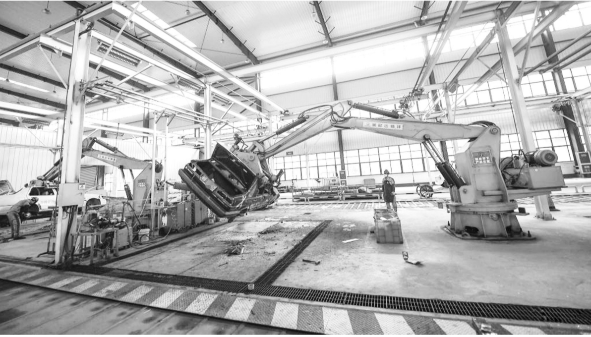
近年来,浙江省湖州市秉承“生态湖州”发展战略,在湖州市吴兴区东林镇成立机动车回收拆解企业,通过全室内作业、危废规范化管理等举措,推动传统人工拆解向自动化机械拆解转变,提高拆解效率和效益。图为当地一家机动车回收拆解企业的作业现场。
