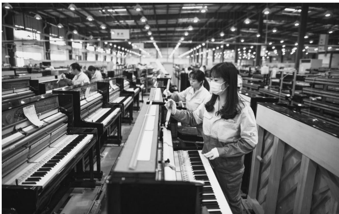
湖北宜昌长江江畔的柏斯音乐集团宜昌钢琴生产基地是世界三大钢琴生产基地之一，年产钢琴7万多台。图为工人在柏斯音乐集团宜昌钢琴生产基地调弦。
