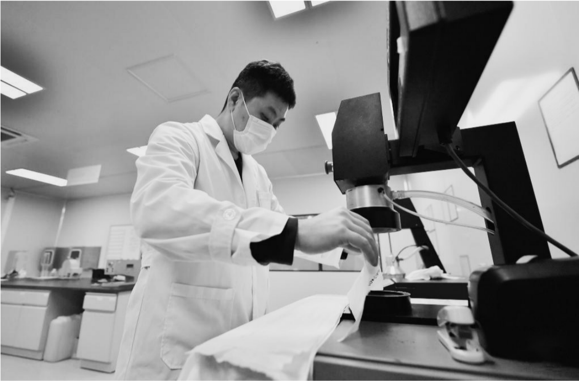
天津泰达洁净材料有限公司生产车间内,工人忙碌在智能化口罩滤材生产线和医用口罩生产线上,保障防疫物资供应需求。图为检测人员对新生产的成品口罩滤材样本进行过滤效率测试。 新华社记者 孙凡越 摄
