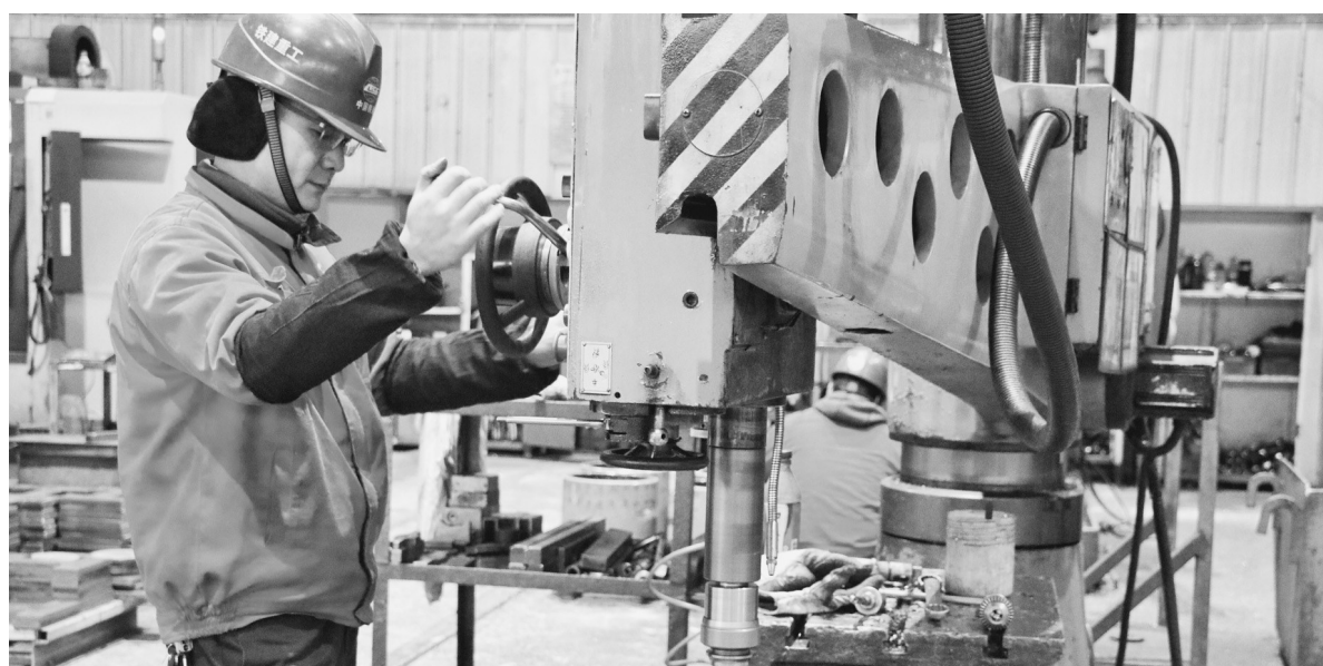
为保证大量订单按时顺利交付,中国铁建重工集团各生产单位提前结束春节假期,迅速进入工作状态,抢抓虎年开门红。在一线车间里,员工们赶生产、忙发货,已是一派热火朝天的景象。图为某海外引水工程双护盾TBM计划3月开始装配,班组正在对变速箱进行机加工序,为部装做准备。
