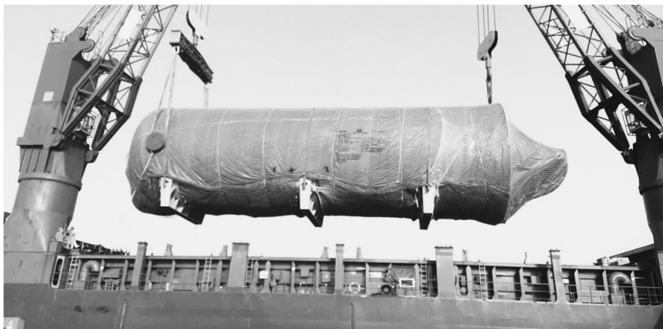
3月16日,在山东省荣成市石岛新港,威海石岛重工为巴西建造的两台特大焦炭塔设备顺利装船启运。该设备直径8米,高度29米,单台重280吨,单台年产针状焦10万吨,采用世界先进的合金材料,外加不锈钢内衬,是美国针状焦生产工艺改造升级的核心替代设备,得到了巴西石油、第三方监理公司的认可。中新社发 杨志礼 摄
