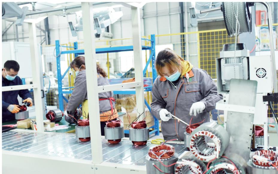
连日来,湖南双峰县农机企业在做好疫情防控的前提下,抓紧赶制订单,满足国内国外市场需求,今年一季度,该县农机产品自营出口492万美元。该县现有各类农机企业85家,拥有从原材料供应到产品研发、制造、销售、服务完整的产业链。2021年,该县规模以上农机企业实现生产总值92.24亿元,产品畅销泰国、印尼、缅甸、尼日利亚等10多个国家和地区。图为在双峰经开区湖南省智科达机电有限公司车间内,工人在生产线上为电机定子嵌线。
