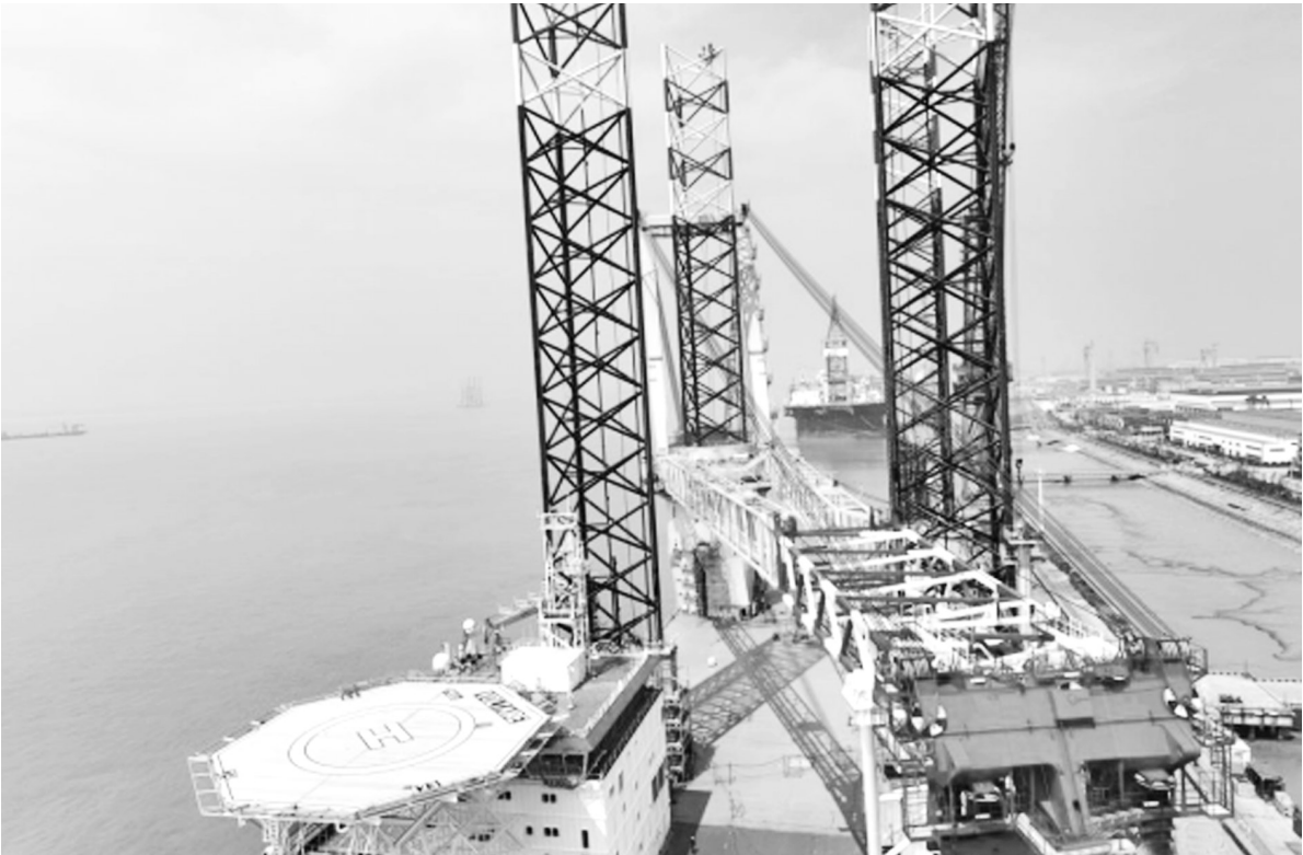
图为在江苏启东中远海运海工码头拍摄的世界首艘3000吨级自升式风电安装船。该船具有起重能力强、操控性好、空间容量大、能耗及排放低等优点，交付后不仅能够安装下一代风电机组和底座，也可用于石油和天然气行业，以及海上结构的拆除。
