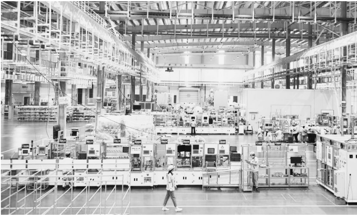
位于浙江省绍兴市主城区的越城区近年来积极推进新旧动能转换,对纺织、家居、黄酒等传统优势行业进行智能化改造,引入集成电路、生物医药等产业,为古城的发展酝酿新动能。图为越城区绍兴三花新能源汽车部件产业园即将投产的超级车间。该车间采用U形线单件流设计,主产线实现全流程自动生产。
