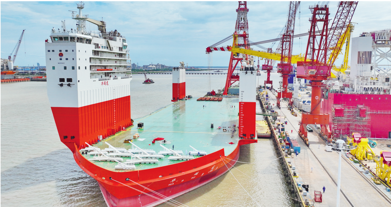
招商工业海门基地为交通运输部广州打捞局建造的8万吨半潜打捞工程船近日正式交付。8万吨级半潜船“华瑞龙”是目前中国第二大半潜船,也是亚洲第一艘无常规舰楼、四岛式设计新型半潜打捞工程船。
