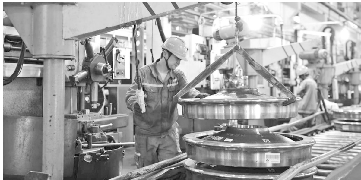
位于湖南省株洲市的中车株洲车辆有限公司加紧生产,赶制国内外客户订单,全力保障产品如期交付,近期即交付铁路货车1450辆。图为在该公司转向架工区,工人在生产线上作业。新华社记者 薛宇舸 摄
