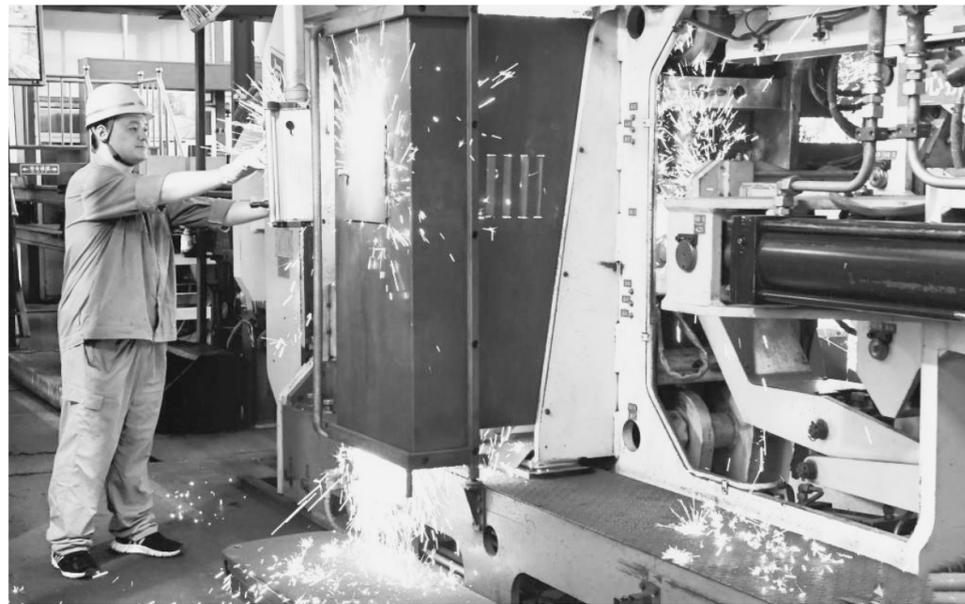
在焊接生产台与工艺试验室间来回奔走，探索不同型号钢轨性能，分析调整焊接参数，把控工艺生产流程……这是无缝钢轨焊接工艺技术员的工作日常。作为中国铁路郑州局集团有限公司郑州工务机械段焊轨车间的一名工艺技术员，自2011年工作以来，罗宇航累计焊接高铁无缝钢轨3000多公里，取得了4.8万个焊头零误差、零事故的工作成绩。
