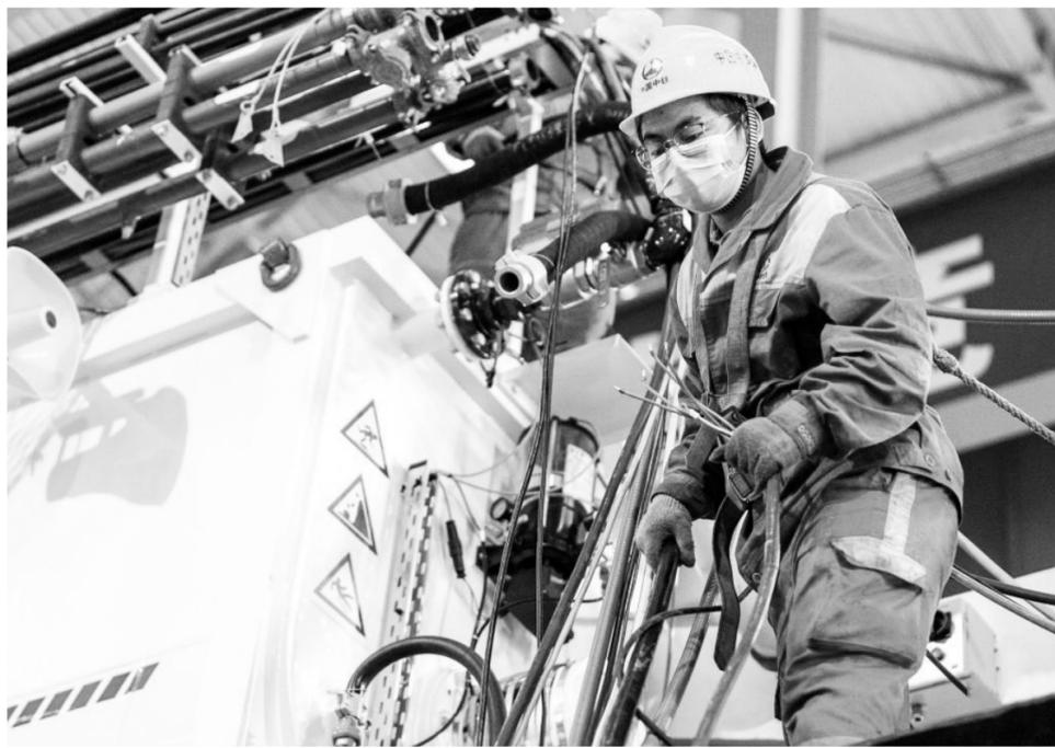
近年来,在推动中国掘进机“走出去”的过程中,中国中铁工程装备集团有限公司不断创新研发,加紧生产,积极拓展并深耕海外市场。目前,公司产品累计出口至意大利、法国、新加坡等30多个国家和地区。图为工人在中铁装备集团车间内进行掘进机拖车管架拆除作业,方便出口运输。
