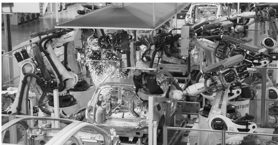
位于浙江宁波余姚的一家国产新能源车型生产基地——领克汽车余姚工厂自开工以来生产繁忙，当前复工率达到100%，产能完全恢复，国际市场订单需求也在持续增加。图为该厂的焊装机器人对车辆车架进行焊装。
