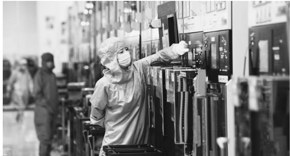
近年来,西部(重庆)科学城大力实施智能制造培育工程,引导企业“机器换人”“上云上平台”,加快智能化改造和数字化转型升级步伐,助力当地工业发展提质增效。图为西部(重庆)科学城华润微电子重庆园区工人在8吋功率半导体晶圆生产车间作业。新华社记者 王全超 摄
