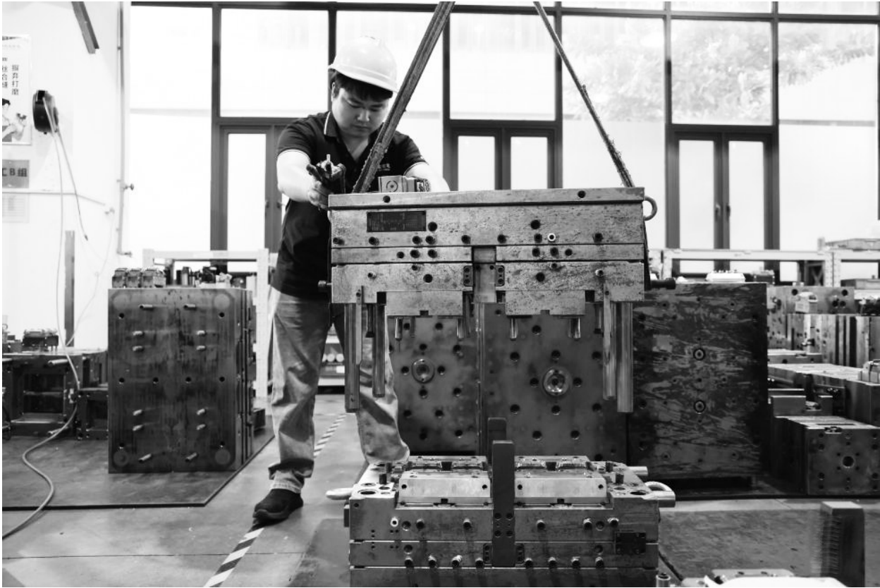
广东省东莞市近年来聚焦智能硬件、潮玩等领域的精密模具研发制造，运用“AI+工业互联网+智能制造”技术，打造国际化模具制造与产品注塑智能工厂。图为在东莞某智能工厂数字化车间，技术人员正在进行模具合模。
